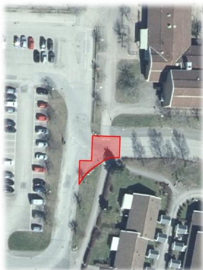
Figur 47. Övergångstället som korsar Lunnevivägen kan kompletteras med mittrefug. Flygfoto från Lantmäteriet.
