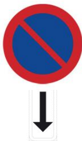
Figur 18. C35 Förbud att parkera fordon tillsammans med tilläggstavla T11-2 med nedåtriktad pil.
